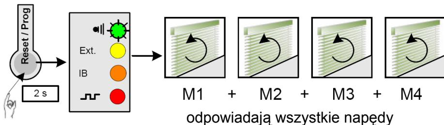
Po włożeniu karty radiowej i wprowadzeniu sterownika w tryb zmian konfiguracji (naciśnięciu przycisku Reset/Prog na 2 sekundy) wszystkie podłączone napędy odpowiedzą krótkim ruchem. Następnie na pilocie RTS należy wybrać żądany kanał i zaprogramować go – naciskając przycisk programowania na pilocie na 1 sekundę, po tej czynności – odpowiedzą wszystkie podłączone napędy.
