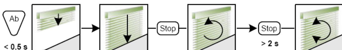
W celu zapisania w sterowniku pozycji komfortowej należy osłony ustawić w żądanej pozycji. Po zatrzymaniu osłony przy użyciu przycisku STOP należy ponownie nacisnąć przycisk STOP na czas powyżej 2 sekund (do chwili aż napęd odpowiedzie od krótkim ruchem). Po potwierdzeniu przez napęd pozycja komfortowa została zapamiętana.
